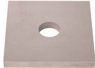
SKD11材20mm厚 \Phi 0.25 黄铜丝 6次加工 \Phi 50mm 真圆度 0.90 \mu m
