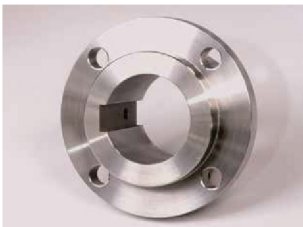
不锈钢40mm厚 \Phi 0.20 黄铜丝 2次加工 键槽加工 形状精度 \pm 5.0 \mu m 加工速度 比以往提高13%
