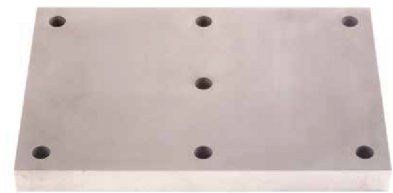
SKD11材25mm厚 \Phi 0.25 黄铜丝 6次加工 \Phi 15mm 步距精度 -1.2 \mu m~+1.0 \mu m
