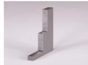
SKD11材10-50-100mm厚 \Phi 0.25 黄铜丝 4次加工 形状精度 \pm 3.0 \mu m 光洁度 Ra 0.36 \mu m
