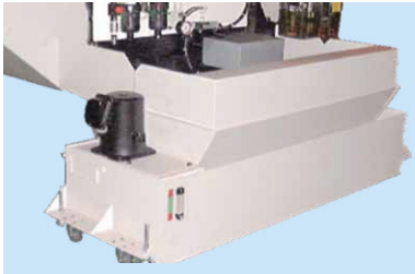
切削液装置 (水槽部分)
